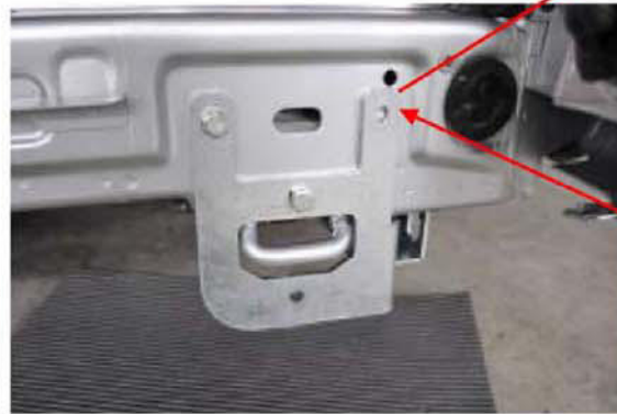
Adapter dient hierbei als Bohrschablone.
