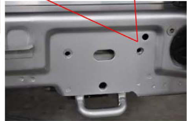
Adapter dient hierbei als Bohrschablone.
