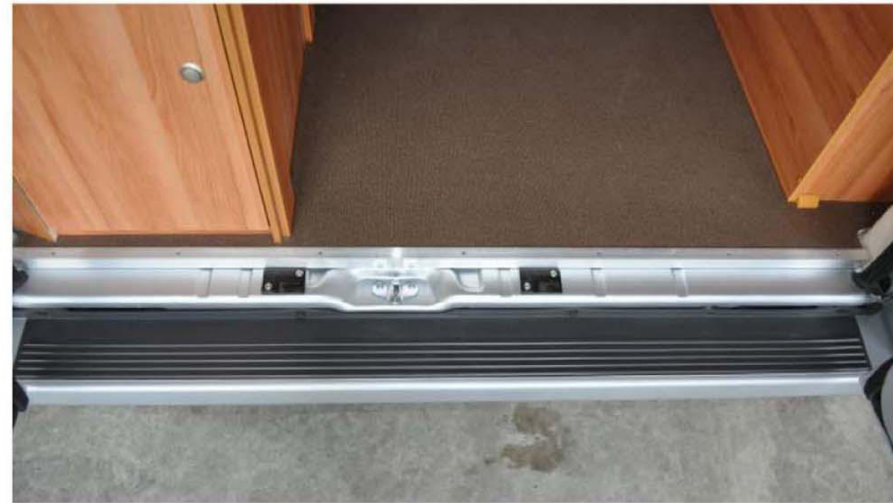
Aufgrund der eingebauten Adapter, lässt sich der Kunststoff- Stoßfänger nicht mehr ganz plan ans Fahrzeug schrauben. Dies wirkt sich jedoch nicht auf dessen Stabilität aus!
