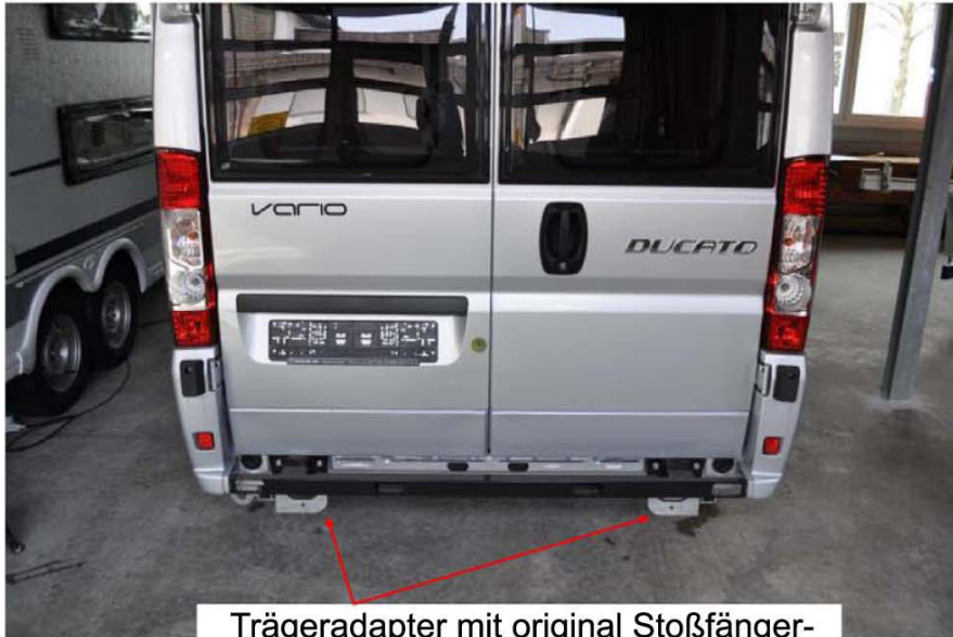
Aufgrund der eingebauten Adapter, lässt sich der Kunststoff- Stoßfänger nicht mehr ganz plan ans Fahrzeug schrauben. Dies wirkt sich jedoch nicht auf dessen Stabilität aus!
